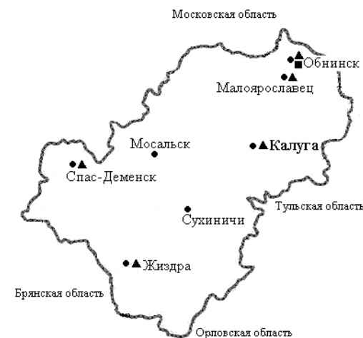
Рис. 4.8.1. Стационарные посты наблюдения СРМ Росгидромета на территории Калужской области: ● – наблюдения за \gamma -фоном, ▲ – отбор проб атмосферных выпадений, ■ – наблюдения за атмосферными аэрозолями (ВФУ)
