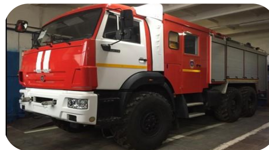
Пожарная автоцистерна АЦ-6,0-70(43118) вместимость: цистерны – 6000 л пенобак – 360 л число мест – 6 человек
