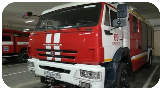
Пожарная автоцистерна АЦ-3,2-40/4(5387) вместимость: цистерны – 3200 л пенобак – 200 л число мест – 6 человек
