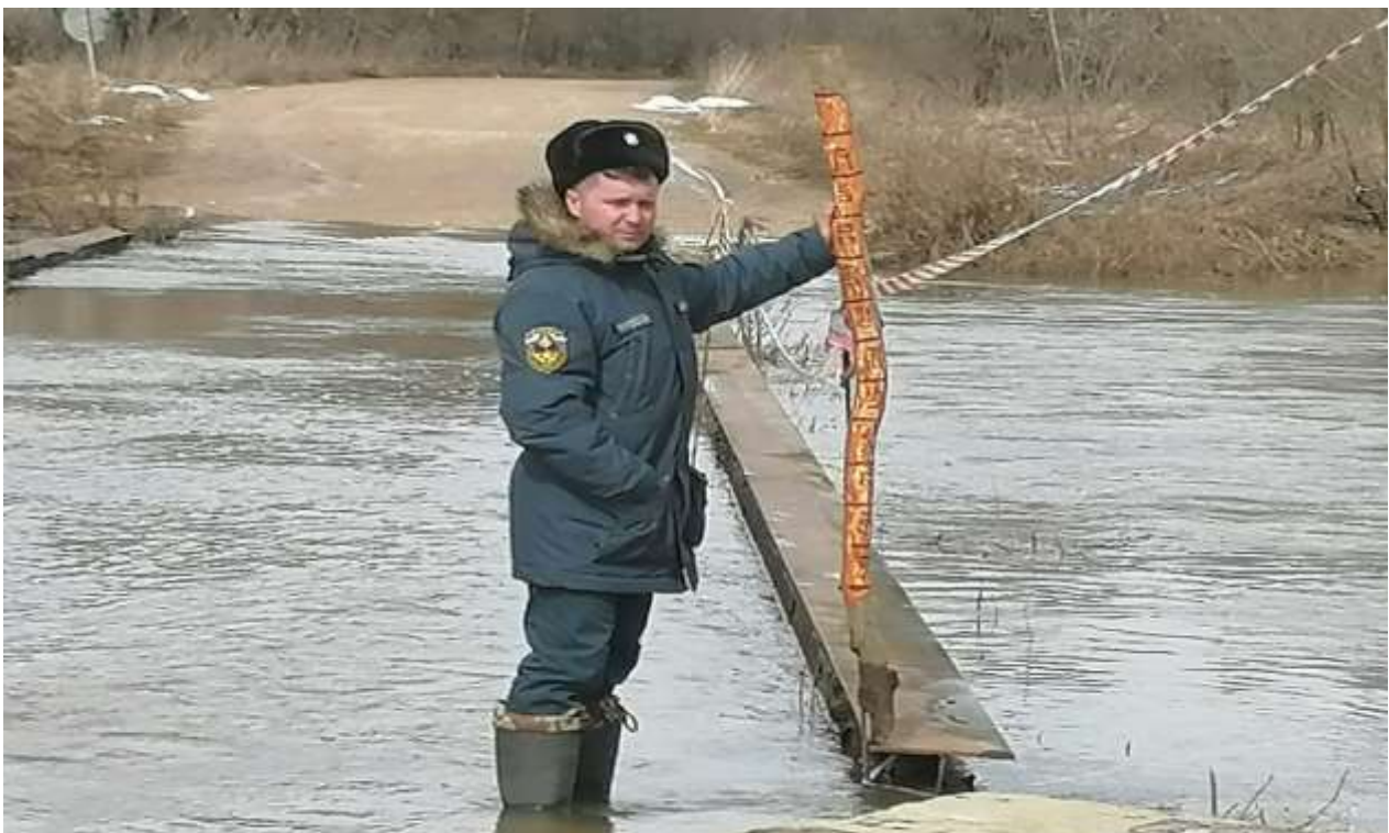
Измерение уровня воды в реке Луже в р-не н.п. Игнатьевское Малоярославецкий района (водомерный пост) 09.04.2021
