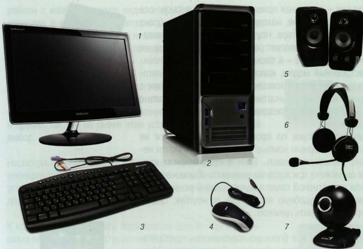
1) Монитор, 2) системный блок, 3) клавиатура, 4) мышь, 5) колонки, 6) наушники, 7) веб-камера
